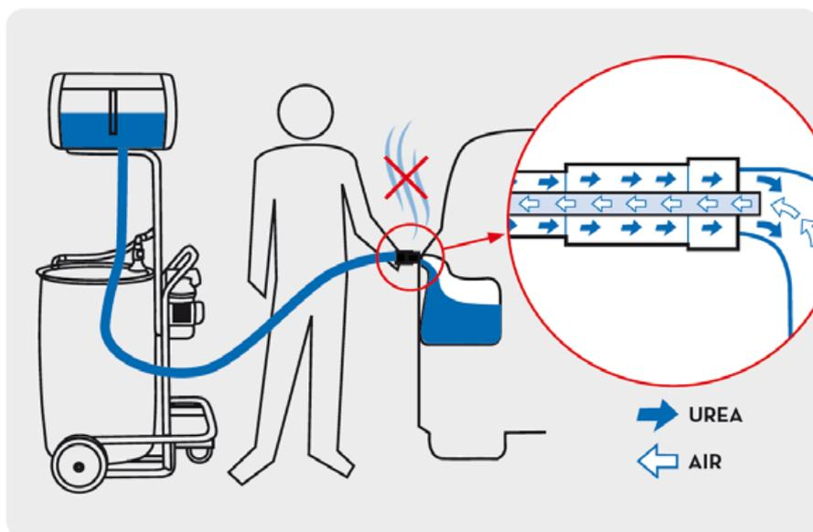
El Dispensador de AdBlue no puede ser contaminado, de ningún modo por agentes exteriores, gracias al innovador sistema de abastecimiento. El aire presente en el depósito del automóvil es desplazado al depósito superior durante el suministro al automóvil.
