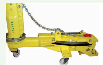
Polea de reenvío para tiro bajo. La ele cuenta con brazos de refuerzo que le dan mayor capacidad de tiro.
