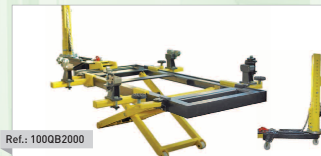
QB2000 MÓVIL, banco de tiro rápido móvil para la preparación rápida de vehículos. El brazo puede fijarse en cualquier posición alrededor del banco.
