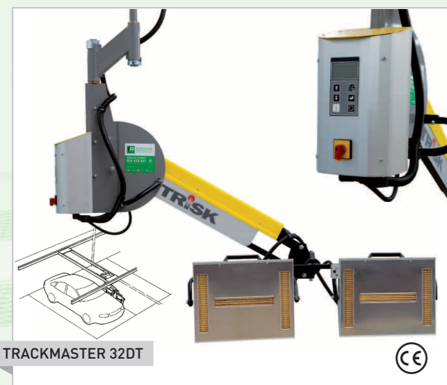
TRACKMASTER 32 DT Equipo de infrarrojos aéreo con sistema de raíles eléctricos. Gran facilidad de manejo. Temperatura de hasta 170° C para conseguir un secado rápido. Puede incorporar un sistema informático para regular su funcionamiento.
