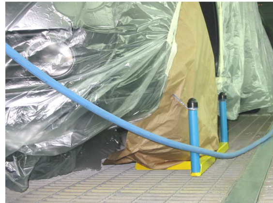
Paso 4. Rodillo que evita que la manguera se enganche en la rueda.
