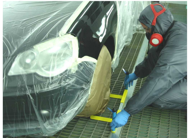
Paso 2. Encajar el kit desligador
